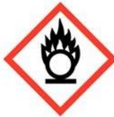
Materiali comburenti GHS03
